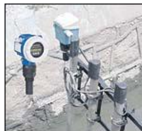
Figura 1: Medición ultrasónica del flujo al vertedero más pH, conductividad y turbiedad.
